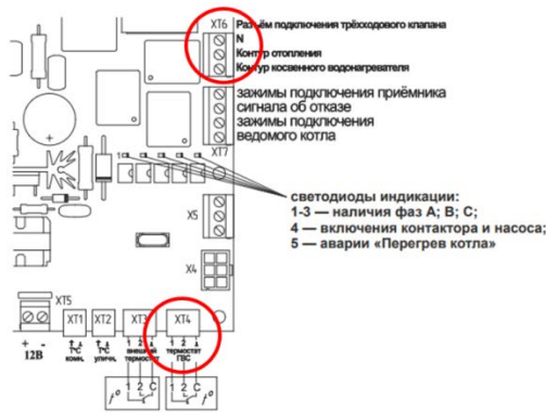
Схема подключения датчика температуры бойлера
